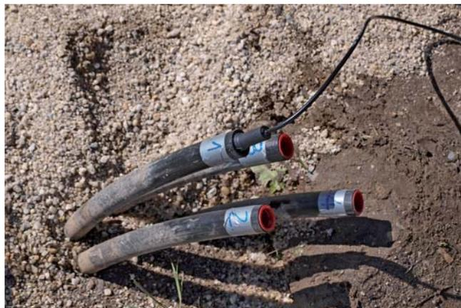
Befahren der Sondenrohre zur Messung der Bohrlochverfüllung.
